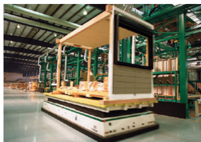
システム住宅の工場内を移動する無人のロボット台車
