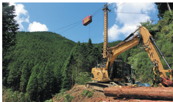
「ICT街づくり推進事業」に採択された岡山県真庭市の「里山真庭の森林づくり推進事業」：タワーヤーダを活用した施業
