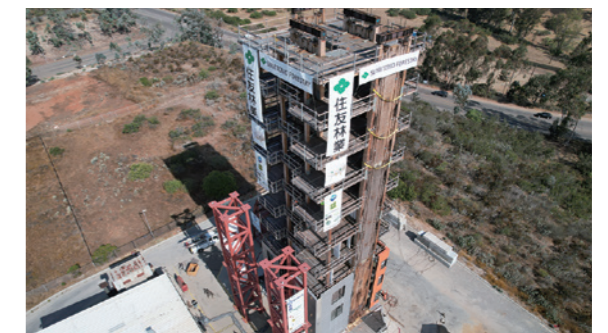
米国カリフォルニア大学サンディエゴ校で10階建木造ビルの実大振動実験
