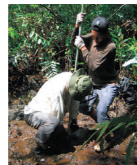
当社が実施した、泥炭地のボーリング調査
