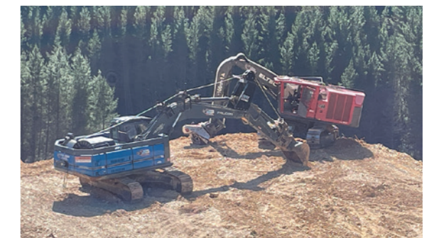
テザーシステム：ウインチマシン(左)、作業マシン(右)
