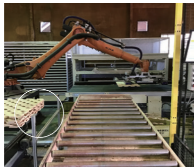
「きづれパネル」の加工
