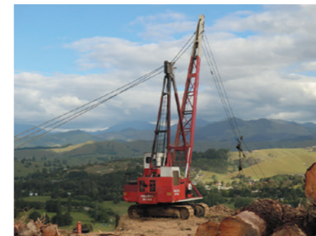
TPF社：タワーヤードを用いた架線集材
