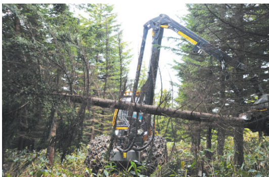
ハーベスタで一貫作業(伐倒、枝払い、造材)
