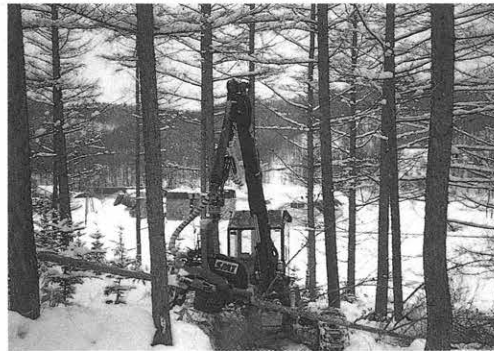
車幅・車高・車体傾斜が自由に調節でき、コンピュータ制御により伐倒から枝払い、玉切りまでの一貫作業を行うハーベスタ（ノルウェー・スウェーデン製）
