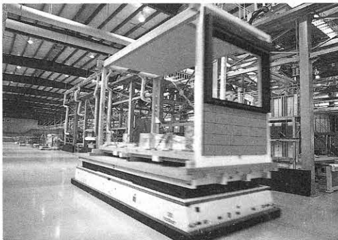
システム住宅の工場内を動く無人のロボット台車
