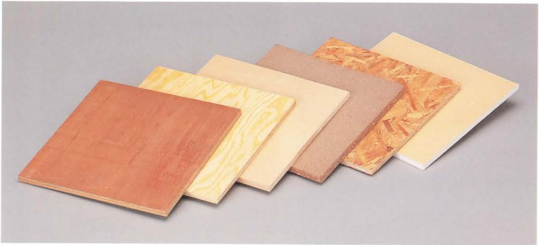
建材のパネル類（左から合板、針葉樹合板、MDF、パーティクルボード、OSB、石膏ボード）
